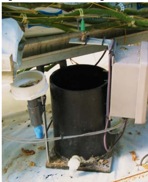
Figure 1 : Bac de lessivage à mesurage automatique
