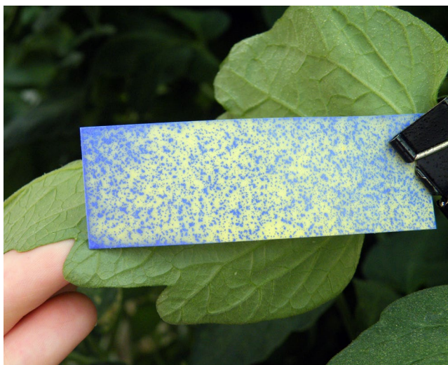
Figure 27. Couverture sous les feuilles avec un pulvérisateur remorqué manuellement à l'aide de cônes creux TeeJet VisiFlo (TX-VK3) fonctionnant à >300 psi.
