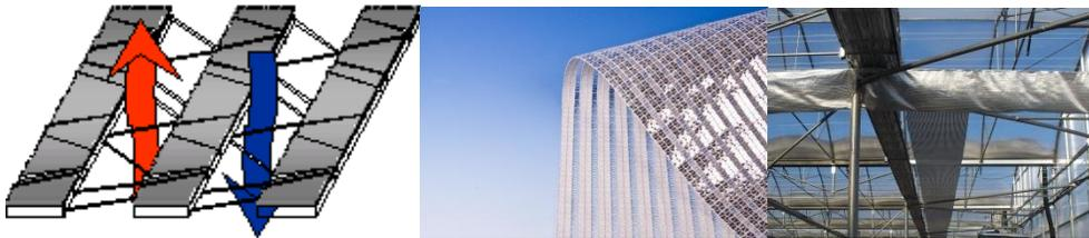
Figure 17 — Écran thermique – Principe d'échange convectif (Svensson, 2012)
