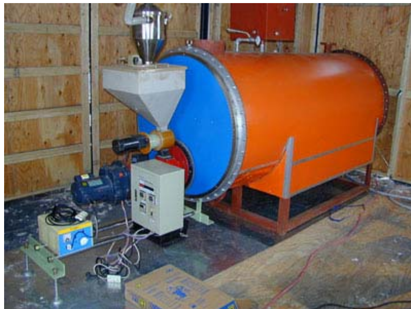
Figure 15 Illustration d'un équipement de chauffage utilisant les briquettes de plastiques développé par GR-Technologies Company inc.
